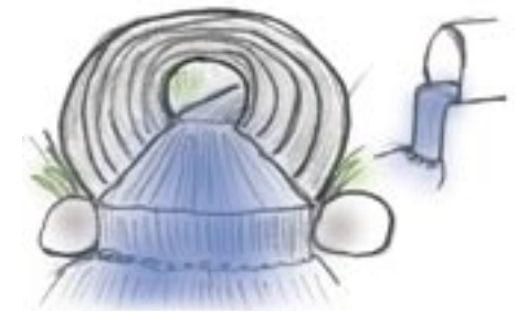
Siltarumpu toimii nousuesteenä
